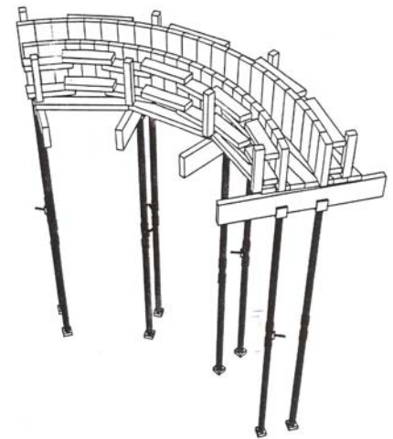
FIGURA 3.43 ENCOFRADO DE VIGA DE DIRECTRIZ CURVA.
