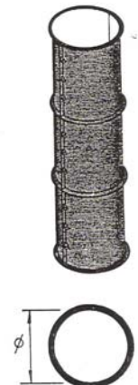
FIGURA 3.23 ENCOFRADO METÁLICO PARA PILARES CIRCULARES
