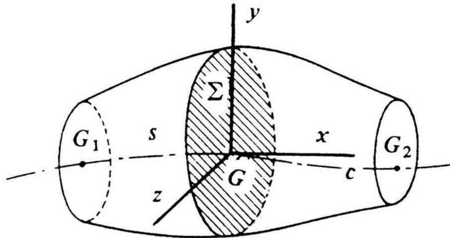
● **Barra.** Se llama así al **prisma mecánico** cuyas dimensiones de la sección transversal son pequeñas, en comparación con la longitud de la línea media.
