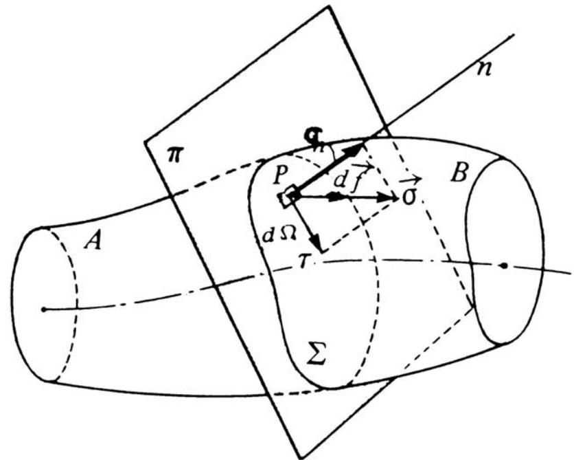
Si ahora suponemos suprimida una de las partes, por ejemplo la B, de la condición de equilibrio elástico se desprende la existencia de una distribución continua de fuerzas  $\vec{df}$ , definida en los puntos de A pertenecientes a la sección  $\Sigma$ , equivalente al sistema formado por la parte del esfuerzo exterior que actúa sobre la parte suprimida.
